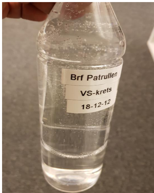
Figur 10. Flaskprov på VS-krets med synliga mikrobubblor.
