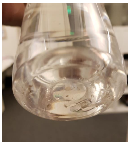
Figur 11. Flaskprovet visade även på magnetit i systemvätskan.
